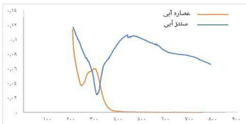
شکل ۱- ادغام طیف UV-Vis عصاره آبی و سنتز آبی نانوذرات نقره شکوفه بادام کوهی
